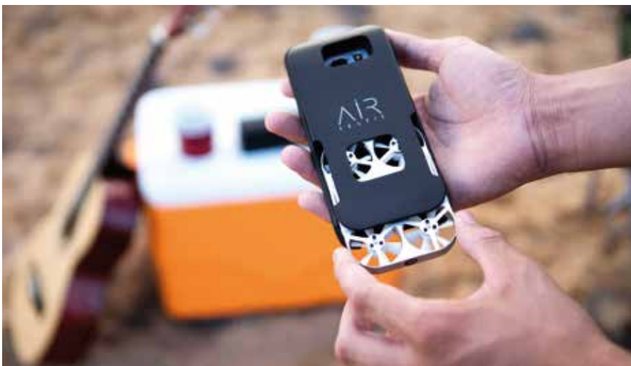
Die nur 61 Gramm leichte Minidrohne AirSelfie kann in ein Handycover integriert werden, um überall dabei zu sein.
