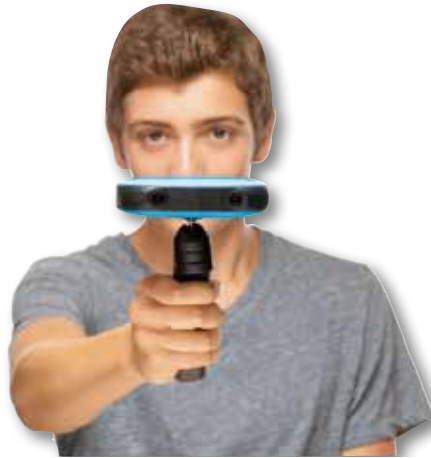
Die 360° 4K-Kamera Vuze nimmt auch stereoskopische 3D-Filme und -Fotos für VR-Anwendungen auf.
